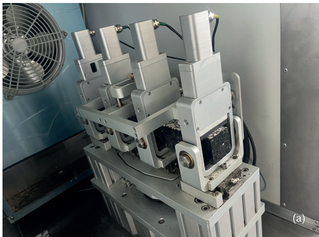
Obrázek 3: Zkušební zařízení pro provádění 4PB zkoušky (Cooper research technology) – (a) 4PB zkušební zařízení; (b) princip zatěžování při zkoušce 4PB
